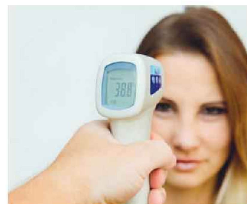
Rys. 17.8. Pomiar długości fali dominującej w promieniowaniu termicznym skóry człowieka pozwala zmierzyć temperaturę szybko i bez kontaktu
