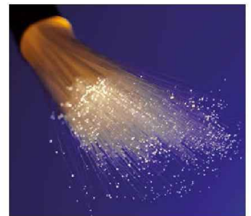
Rys. 16.47. Pojedynczy światłowód służący do transmisji danych ma średnicę włosa
