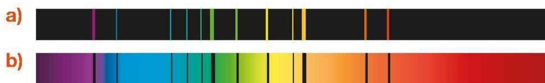
Rys. 17.30. Widmo węgla w stanie gazowym: a) emisyjne, b) absorpcyjne
