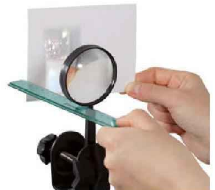
Rys. 16.72. Pomiar ogniskowej soczewki skupiającej
