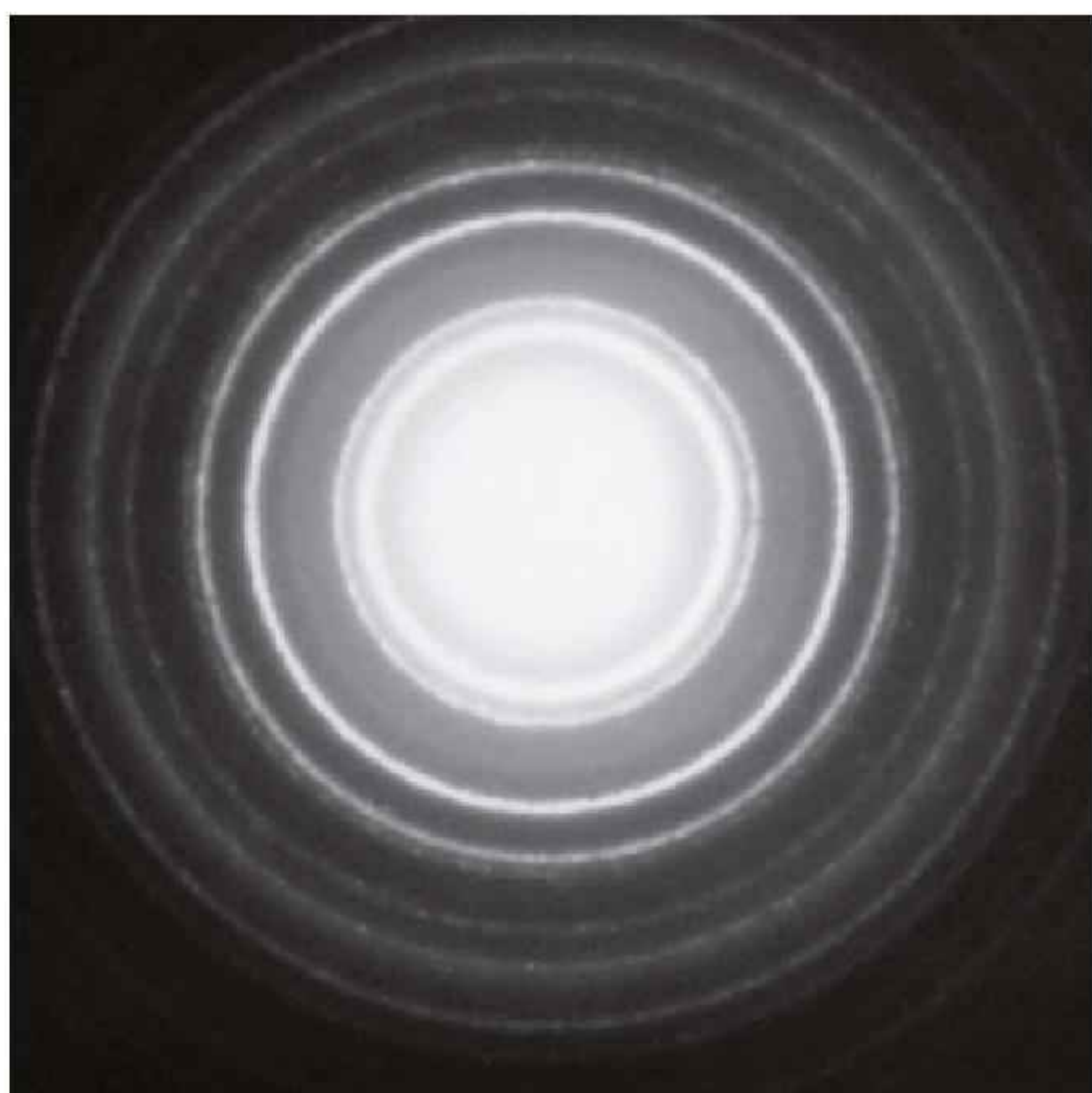
Rys. 17.25. Obrazy interferencyjne uzyskane po dyfrakcji elektronów na sieci krystalicznej cyrkonu (a) i promieniowania rentgenowskiego na kryształach złota (b). Białe i czarne obszary odpowiadają wzmacnianiu i wygaszaniu się fali
