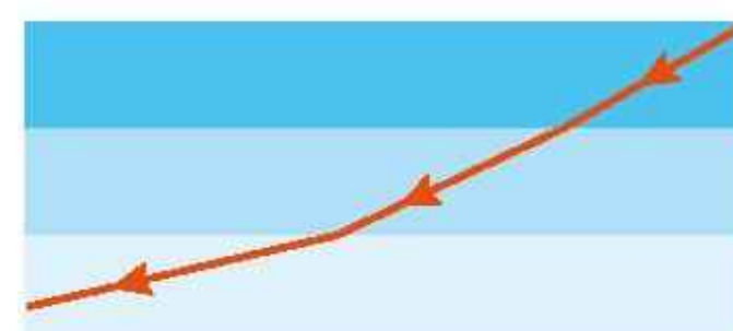
Rys. 16.43. Powstawanie mirażu – ciągła zmiana współczynnika załamania przybliżona przez kolejne zmiany skokowe
