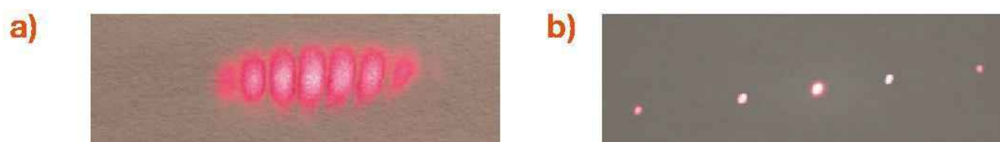
Rys. 16.21. Porównanie obrazów: a) uzyskanego z dwóch szczelin, b) uzyskanego za pomocą płyty CD, na której jest 650 szczelin na 1 mm
