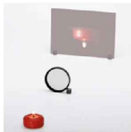
Rys. 16.66. Tworzenie obrazu rzeczywistego przez soczewkę skupiającą: a) układ doświadczalny, b) schemat wyjaśniający przebieg zjawiska
