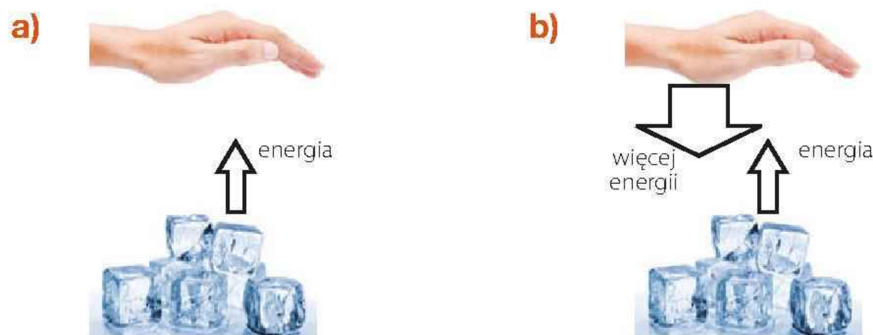
Rys. 17.5. Wymiana ciepła przez promieniowanie między lodem a dłonią: a) schemat niepełny, b) schemat uwzględniający promieniowanie obu ciał
