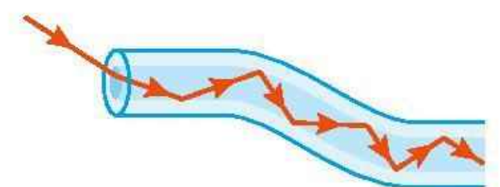
Rys. 16.46. Schemat budowy i działania światłowodu
