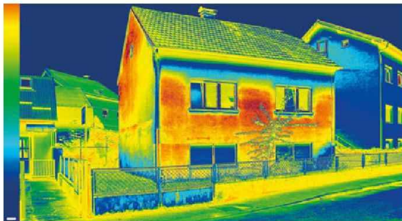
Rys. 17.9. Obrazy z kamery termowizyjnej na zewnątrz (a) i wewnątrz (b) domu
