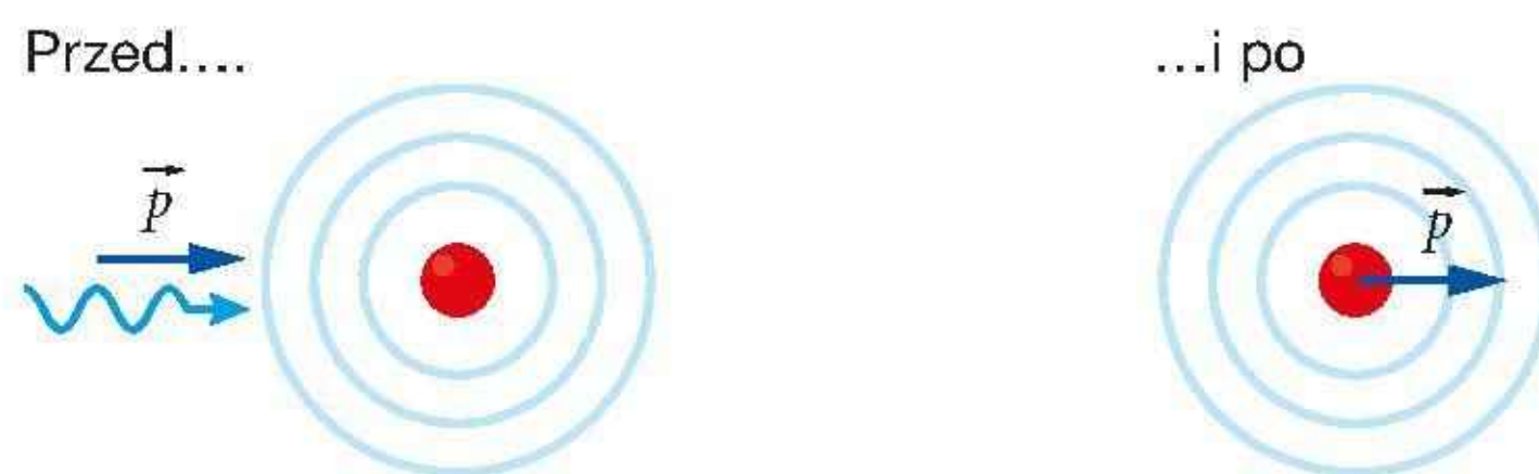
Rys. 17.23. Zmiana pędu atomu przy absorpcji fotonu
