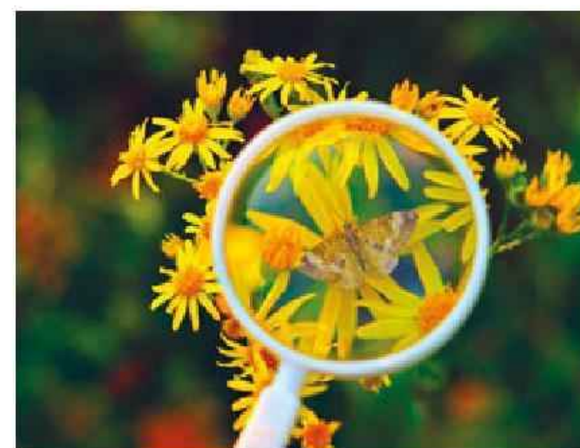
Rys. 16.57. Soczewka skupiająca może służyć do powiększania blisko położonych obiektów
