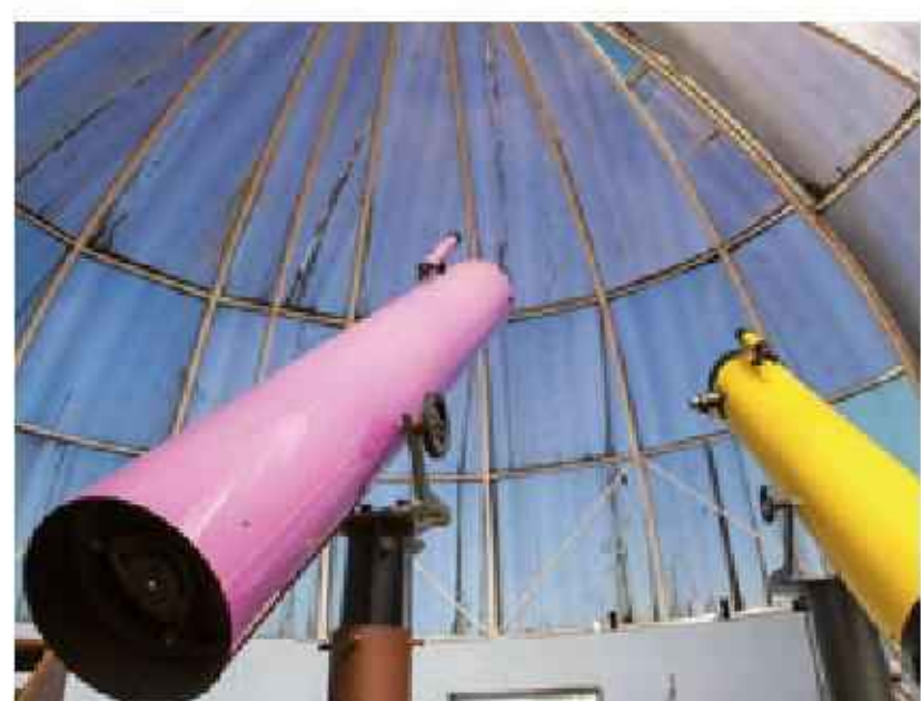
Rys. 16.94. Obudowa przyrządu optycznego powinna być czarna od wewnątrz. Od zewnątrz może być pomalowana choćby na różowo
