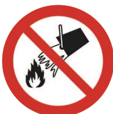
Zakaz gaszenia wodą
