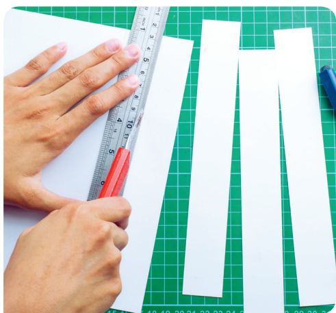
▲ Cięcie papieru z użyciem nożyka i przymiaru
