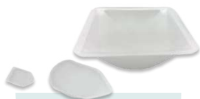
Naczynka wagowe do odważania substancji stałych i ich mieszanin
