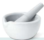
Moździerz do rozdrabniania i ucierania substancji stałych
