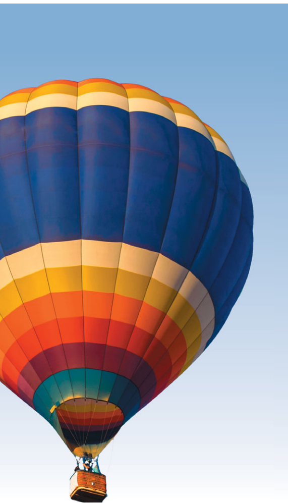
Rys. 4.19. Balon się uniesie, jeśli jego całkowity ciężar będzie mniejszy niż ciężar wypartego powietrza
