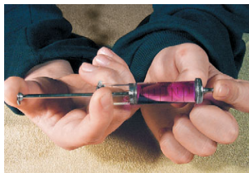
Rys. 2.4. Przesunięcie tłoka w zatkanej strzykawce wypełnionej cieczą jest bardzo trudne, ponieważ ciecze są nieściśliwe
