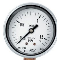
Rys. 1.18. Ciśnieniomierz do pomiaru ciśnienia powietrza w oponach
