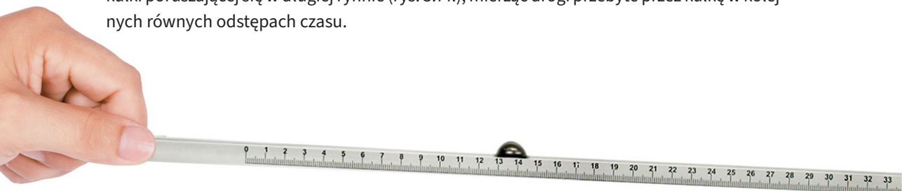
Rys. 3.14. Kulka w stalowej rynnie nachylonej do poziomu porusza się ruchem przyspieszonym
