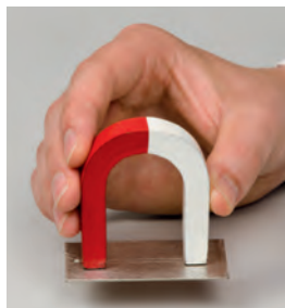
Płytką stalową, której główny składnik stanowi żelazo, jest przyciągana przez magnes.
