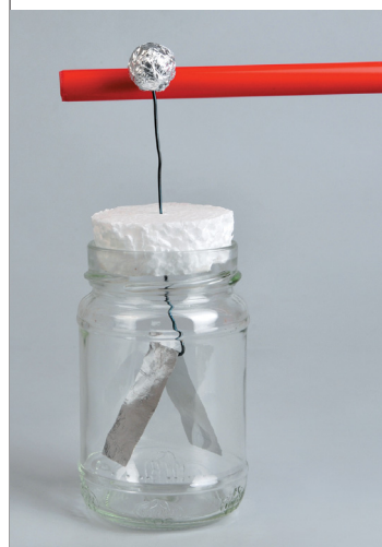
Elektroskop – prosty aparat do wykrywania ładunku elektrycznego
