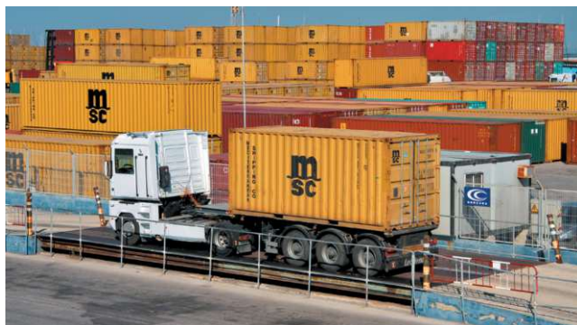
Ważenie ciężarówki z wykorzystaniem wagi znajdującej się w jezdni
